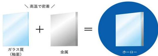
ホーローとは、汚れや湿気に強く、ニオイが付きづらい鉄とガラスの素材です。特にタカラスタンダードの高品位ホーローは鋼板に凹凸を付け、ガラス質との密着力をアップさせているのでとても丈夫になっています。
